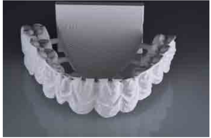
Figg. da 5 a 6b Alcune strutture in fase presinterizzata, l'evoluzione della tecnologia CAD-CAM oggi sempre più diffusa anche in ambito odontotecnico consente la realizzazione di molti dispositivi protesici
